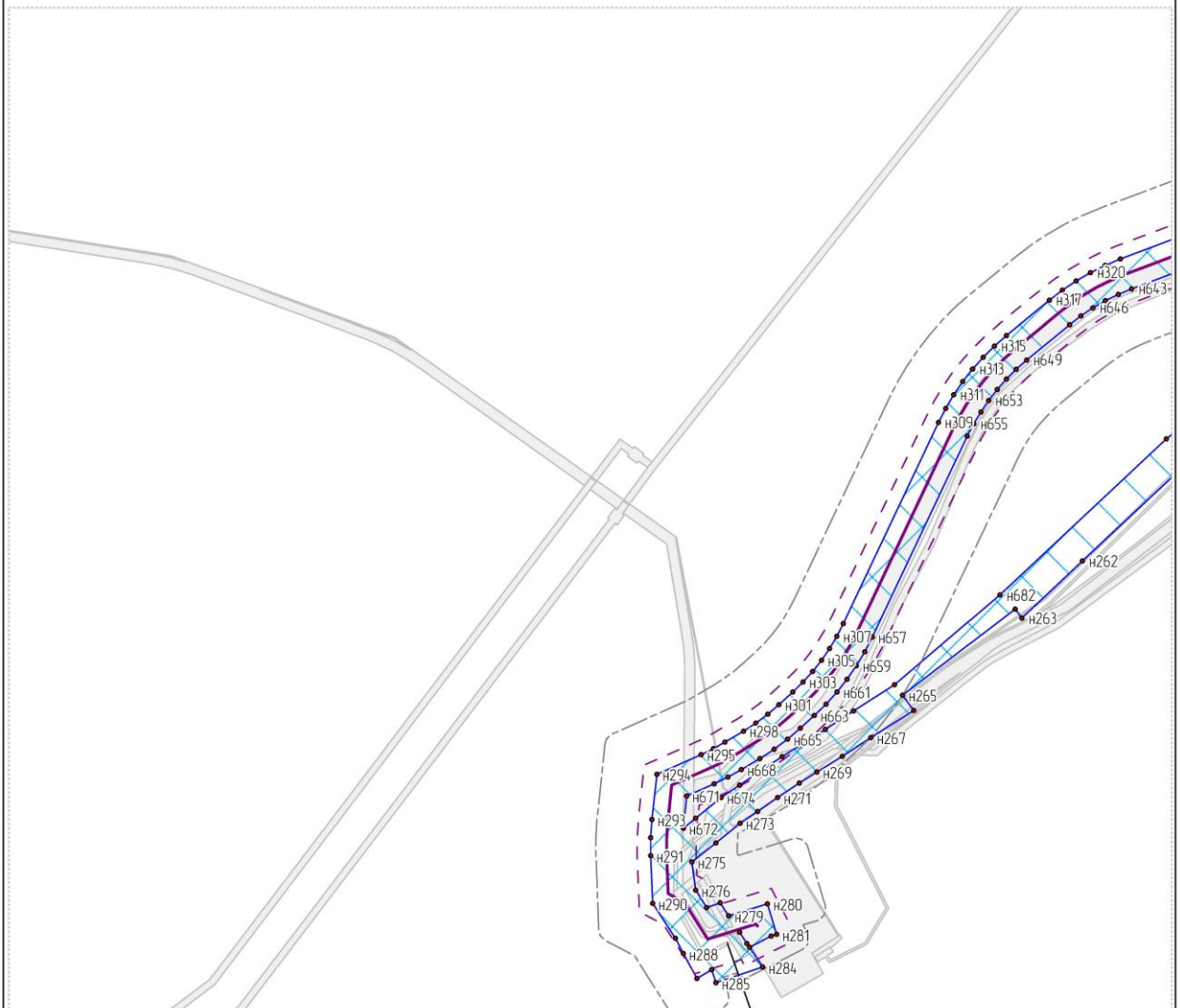
Высоконапорный вадовод (Трасса вадовода от 1 точки 110 до куста скв. 648 (шт.38-к.648) Узел 3А №1
